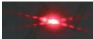
Figure de diffraction de deux cheveux croisés éclairés par une onde plane.
