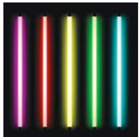
Tubes fluorescents de différentes couleurs utilisant différents matériaux fluorescents.
