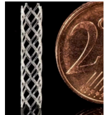
29 ▶ Les lasers permettent l'usinage de précision, comme pour ces endoprothèses destinées à consolider des artères endommagées. La pièce donne l'échelle. © Amplitude Systems
