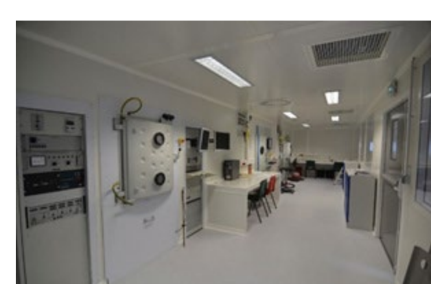
MACHINES DE DEPOT Pulvérisation et évaporation assistées par plasma, en salle blanche
