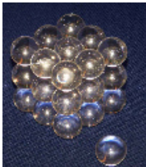
Modèle macroscopique de suie constitué par un agrégat de 27 sphères diélectriques de 15 mm de diamètre chacune.
