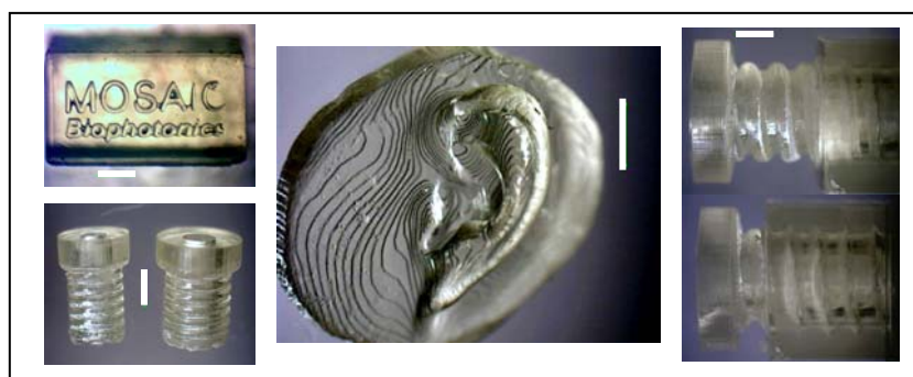
Figure 11 : Exemples de pièces fabriquées au Laboratoire (échelle : barre=1 mm). L'oreille est réalisée avec des couches de polymère de 20 \mu m d'épaisseur.
