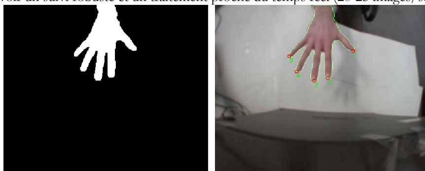
Figure 9 : Segmentation de la main basée sur la couleur de la peau, et détection des bouts des doigts.
