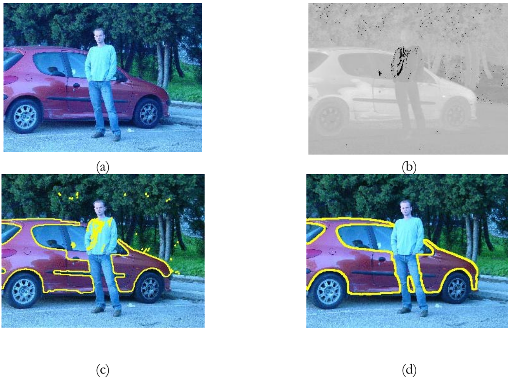
Figure 1 : Segmentation d'une image couleur à l'aide d'une technique par courbe de niveau. (a) Image couleur – (b) Afin de s'affranchir des problèmes d'ombres, il est classique de considérer uniquement la composante de teinte de l'image couleur. – (c) Segmentation obtenue sur l'image de teinte (b) en modélisant les fluctuations des niveaux de gris par des gaussiennes. La teinte étant une grandeur périodique, nous constatons qu'une modélisation gaussienne des fluctuations ne permet pas d'obtenir un résultat satisfaisant. – (d) Segmentation obtenue sur l'image de teinte (b), mais en utilisant cette fois-ci une modélisation non paramétrique des fluctuations des niveaux de gris.
