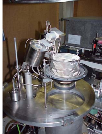
Photo 2b – Bâti IBS ouvert
