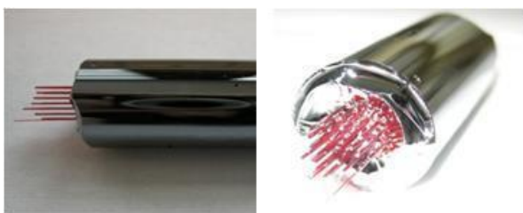
Figure 3.3 : Préforme (avant étirement) de fibre micro-structurée en verre de chalcogénure (ISCR).
